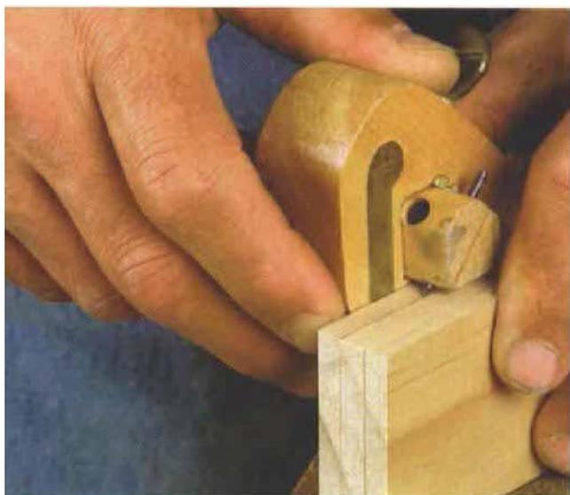
放弃铅笔划线之后，许多木工马上选择了划线器作为划线工具。传统样式的划线器划线时，一般都是用装在其上的铁笔样的尖头划开木材表明纹理，而不是切入木材，划的线通常是一道粗糙的细槽。
